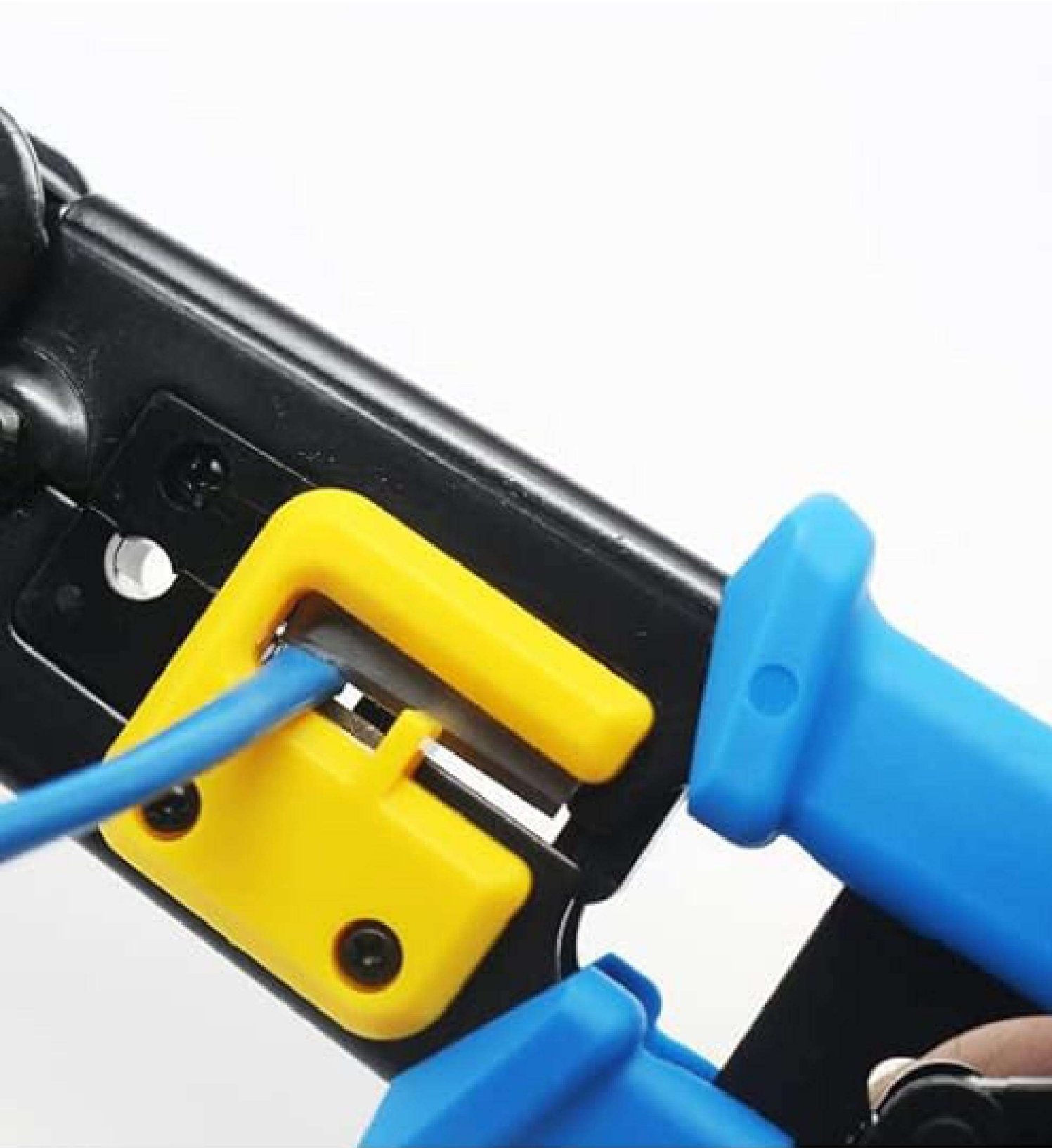
1.Utilice cortadores de alambre para cortar la cáscara. 2. Saque la carcasa del cable de red del cable de red
