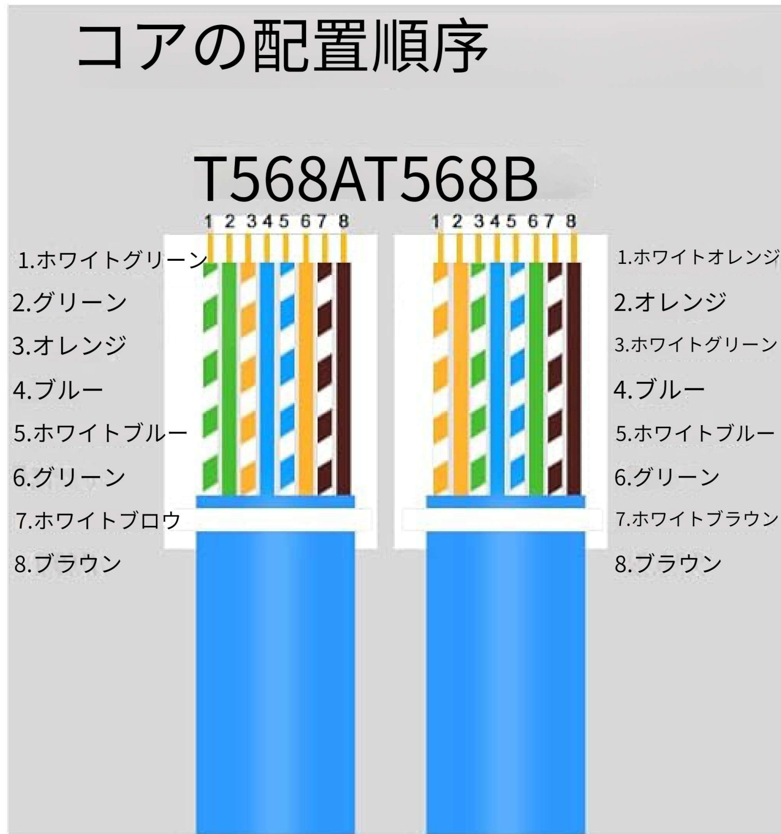
1.ワイヤーカッターを使用してシェルを切断します。 2.ネットワークケーブルシェルを取り出します。 3.芯の順番を整える ネットワークケーブルの
