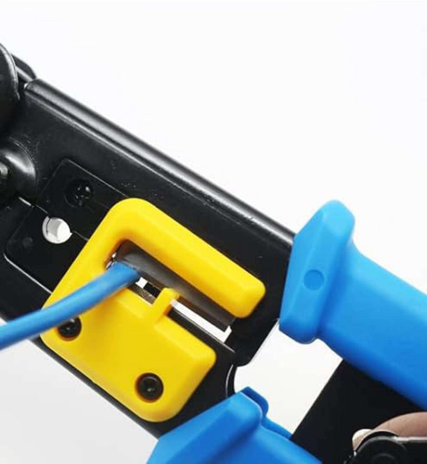
1. Utilisez un coupe-fil pour couper la coque du câble réseau
