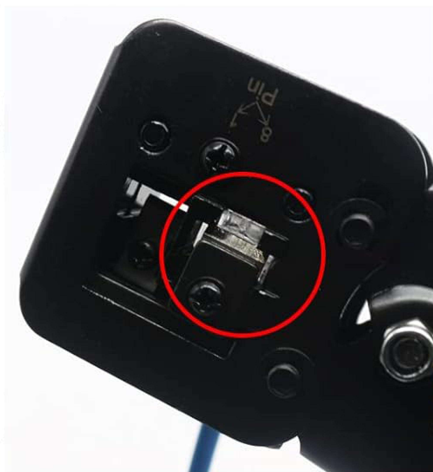
5. Après avoir soigneusement aligné la pince du câble réseau avec la tête de cristal, appuyer fermement
