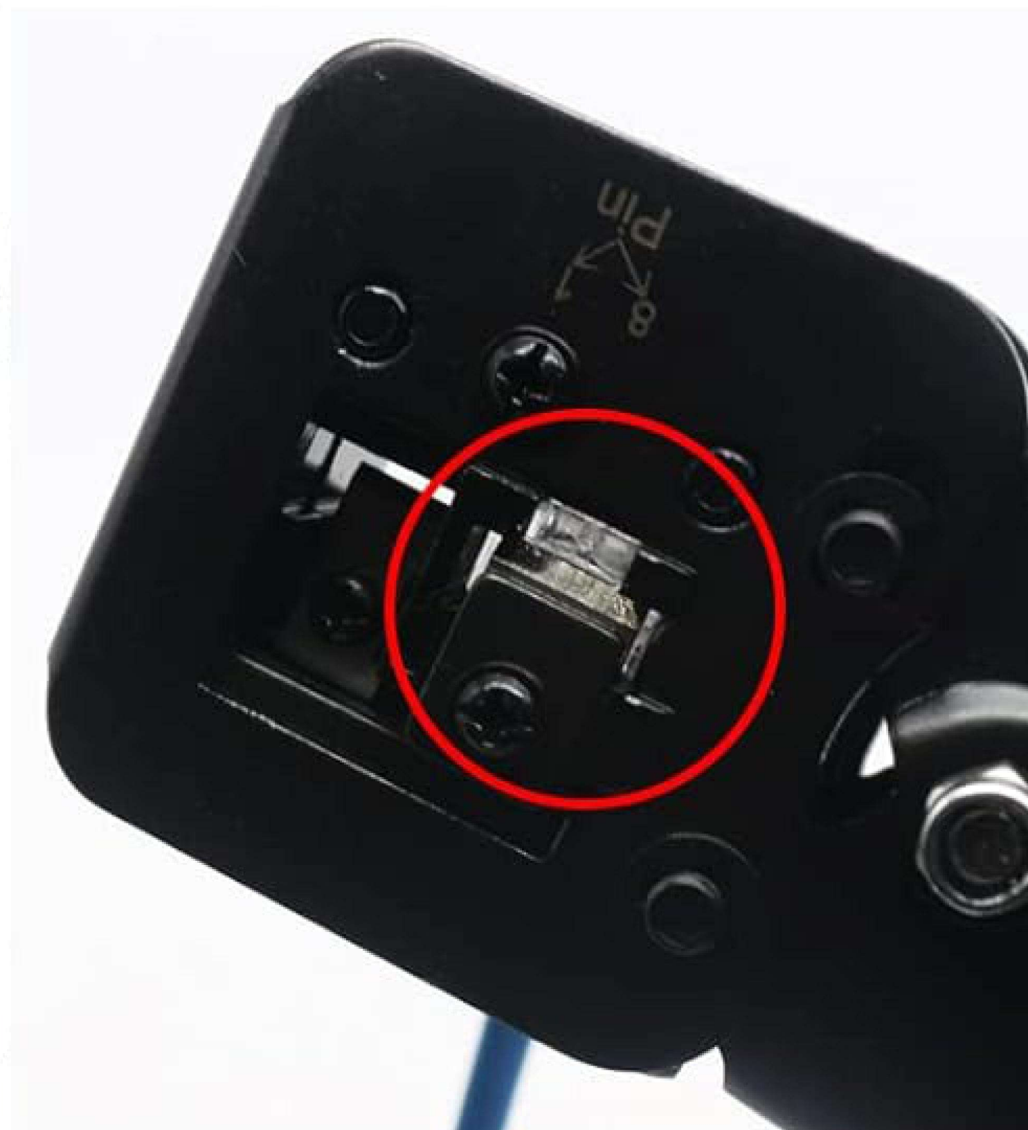
5.ネットワークケーブルプライヤーをクリスタルヘッドにきちんと合わせた後 しっかりと押し下げます
