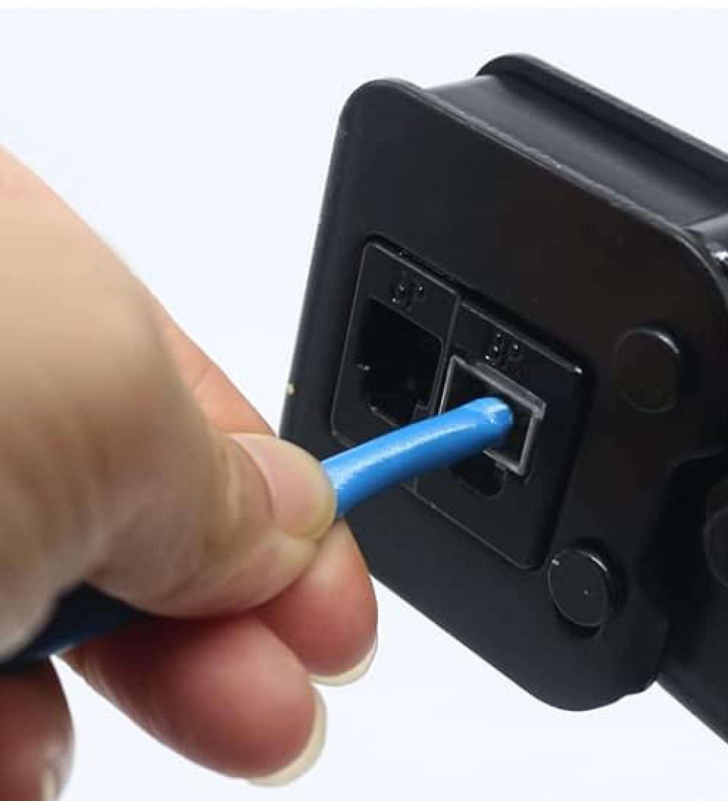
4. Placez la tête de cristal avec le câble réseau dans le serre-câble à l'intérieur du port de sertissage
